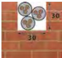
Schlitzten von Kabelkanälen
