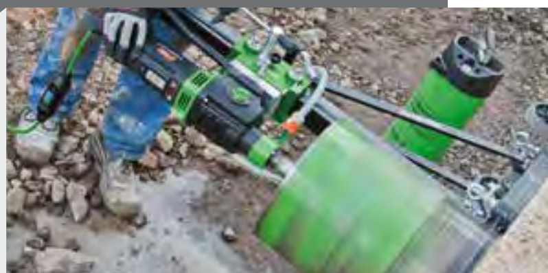
BST 352 V: auf vier Spezialkugeln gelagerter Schlitten
