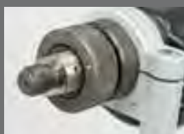
Verstellring für zuschaltbaren Softschlag
